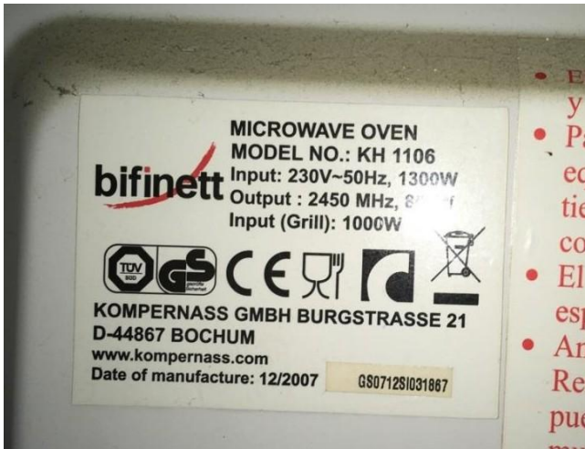
Il·lustració 37: Freqüència del microones utilitzat en tots els experiments, 2450 MHz.
