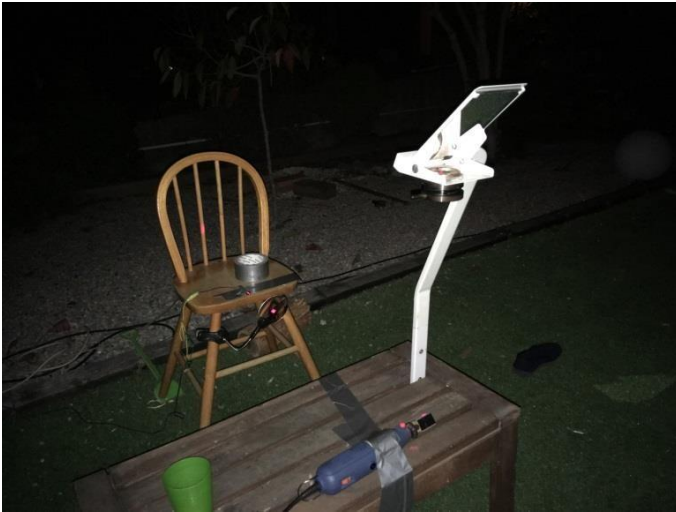
Il·lustració 40: Muntatge casolà del mètode de Foucault.
