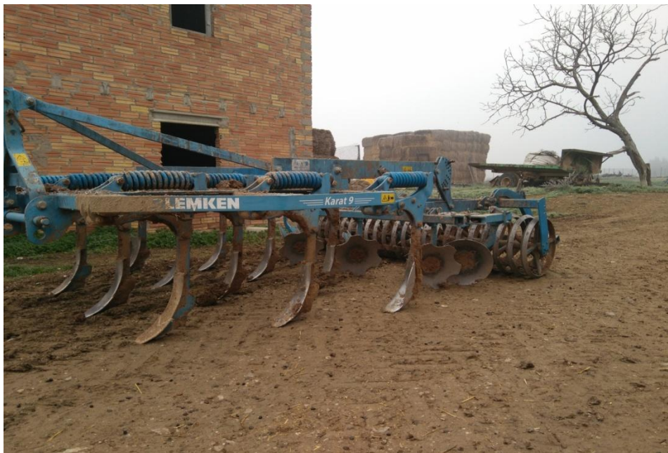
Figura 1 Chissel, maquinaria utilitzada per practicar un trencament del sòl i oxigenar el sòl. (Font: Èlia Capdevila)
