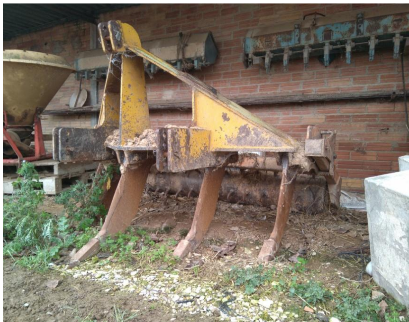
Figura 2 Subsolador, maquinaria utilitzada per practicar un trencament en el sòl i oxigenar la terra. (Font: Èlia Capdevila)
