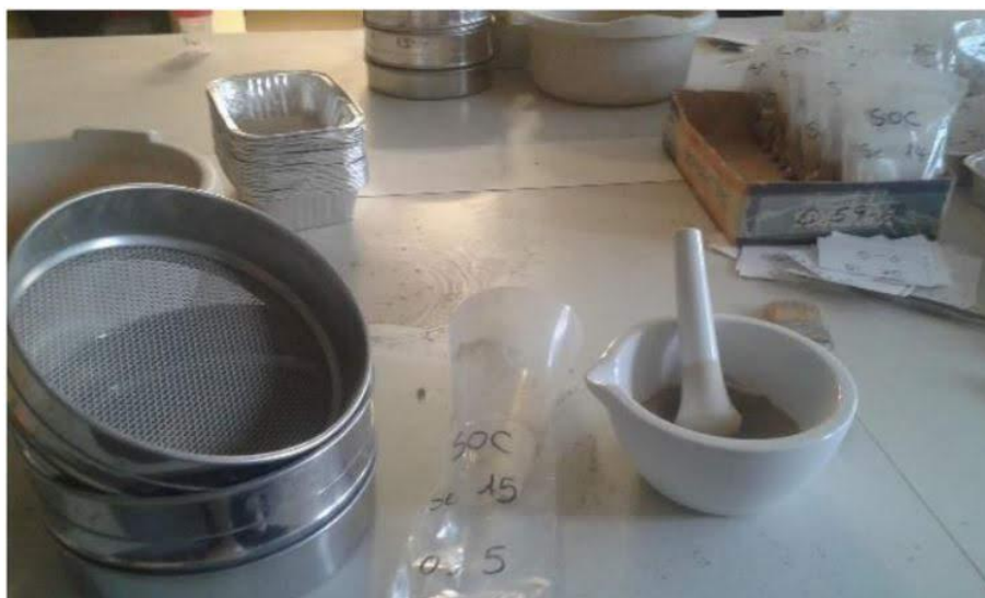
Figura 5 Fotografia del procés de mòlta i tamisat. (Font: Naima, TFM)
