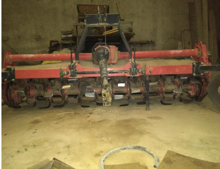
Figura 3 Fresadora, maquinaria utilitzada per deixar la terra fina, preparada per sembrar. (Font: Èlia Capdevila)
