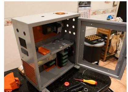
Fig. 14 Caja de drivers montada
