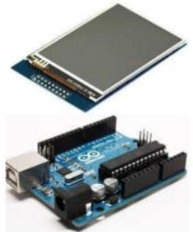
Fig. 23 Pantalla TFT y Arduino UNO
