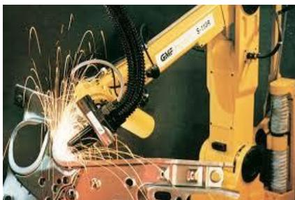
Fig. 5 Brazo robot industrial Soldador
