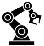
consigue con 3 ejes o grados de libertad dividiéndose en un movimiento rotacional de la base, un movimiento angular entre la base y el brazo y otro lineal para la extensión del brazo.
