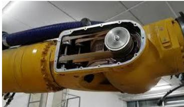
Para la transmisión del motor al respectivo eje donde queremos que se produzca el movimiento dentro del brazo actúa un ingenioso mecanismo de poleas y cuerdas dentadas que facilita esta rotación de los ejes.
