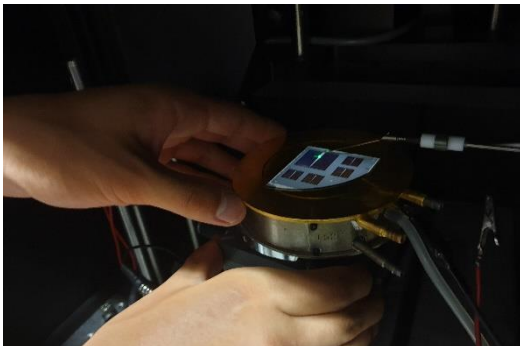
Il·lustració 41 Intentem posicionar la cèl·lula fotovoltaica sota la llum blanca
