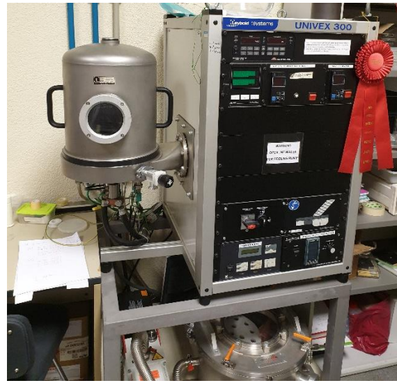
Il·lustració 50 Equip per a dipositar capes fines de diferents materials
