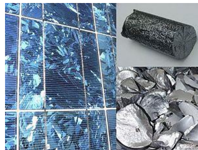
Il·lustració 30 Procés del silici monocristal·lí a silici policristal·lí Font: Wikipedia
