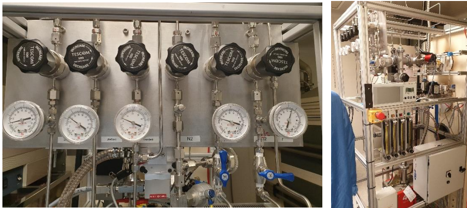
Il·lustració 47 Lloc on es controlen els diferents gasos que serveixen com a flux d'aire
