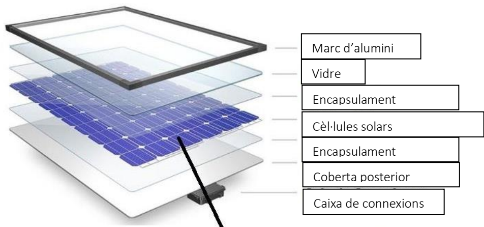
Il·lustració 25 Estructura d'una placa fotovoltaïca Font: Público
