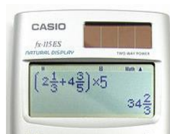
Il·lustració 31 Cèl·lula fotovoltaïca de silici amorf en una calculadora Font: Wikipedia
