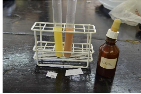
Il·lustració 44 Resultat de l'experiment: A l'esquerra el tub amb suc de taronges ecològiques on encara queda vitamina C per oxidar. A la dreta podem veure el pot de Lugol.
