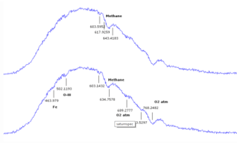
Figura 10. Gràfica espectre absorció de Saturn on es veu l'absorció del metà (Font: http://www.rkblog.rk.edu.pl/w/p/saturn-absorption-bands-recorded-star-analyser/ )
