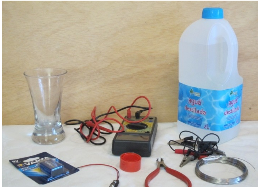
Imatge 8: Material utilitzat en la construcció de la pila d'hidrogen casolana, segons el disseny 1
