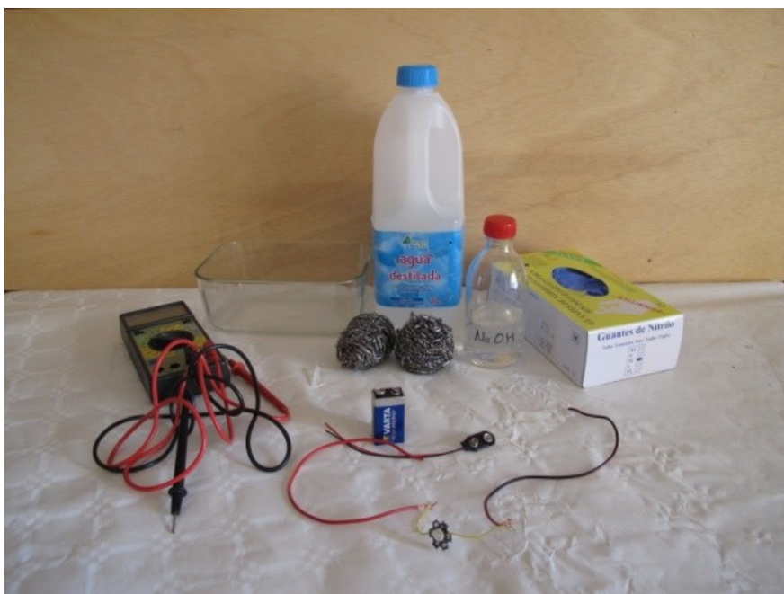
Imatge 12: Material utilitzat en la construcció de la pila d'hidrogen casolana, segons el disseny 2
