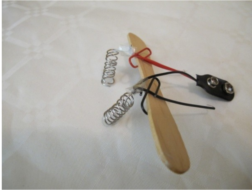
Imatge 10: Clip de bateria connectat a les espirals (subjectades a l'espàtula de fusta)
