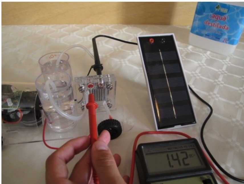
Imatge 22: Generació de corrent a través de la placa solar del kit comercial
