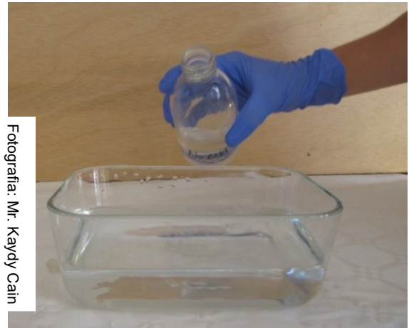
Imatges 13 i 14: Introducció de la dissolució de NaOH al recipient (amb aigua destil·lada) del disseny 2
