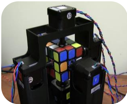
Il·lustració 6: Màquina que resol el Cub de Rubik
