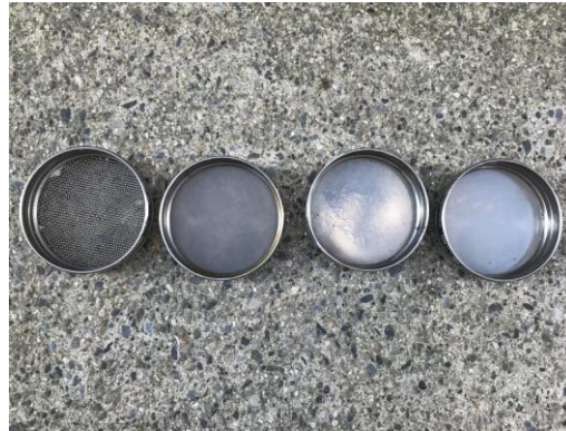
Font pròpia. Sedassos graduats: 2mm, 0,2mm, 0,05mm i 0,025mm
