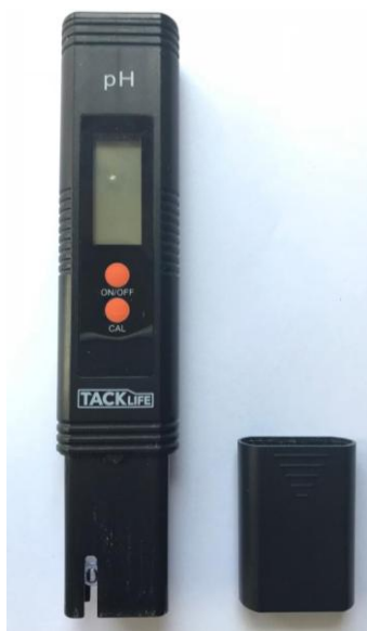
Font pròpia: pH-metre adquirit per realitzar aquestes pràctiques
