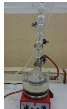
Fig. 37. Equip de reflux
