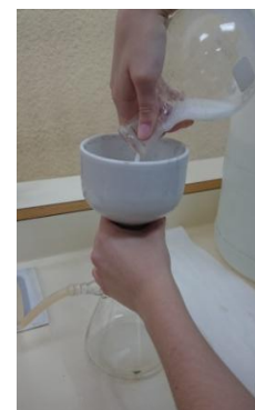
Fig. 38. Filtració al buit
