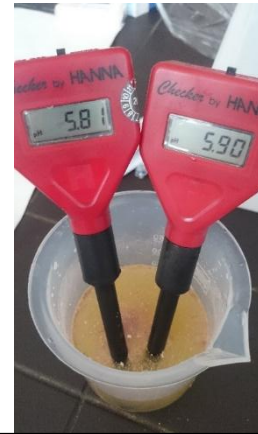
Fig. 46. Presa del pH de Bion protect amb els dos pHímetres
