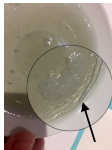
Figura 77: Bioplàstic 3 començament de solidificació
