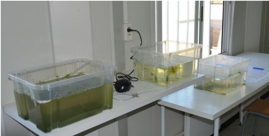
Figura 16 Reactors finalitzats. El reactor petit s'ha utilitzat per recollir les dàfnies del riu
