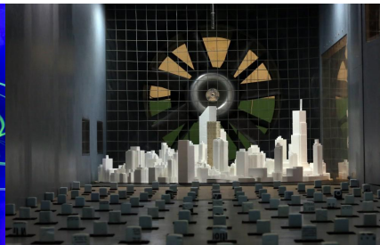
Il·lustració 14: Experimentació de les forces aerodinàmiques que afecten els edificis d'una ciutat (Font: Gradient Wind Engineering)
