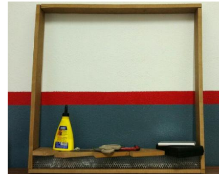
Il·lustració 42: Parts del laminador. El marc de fusta a sota i les palletes i les barres col·locades a sobre. (Font: Pròpia)
