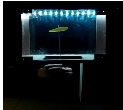
Quan l'ala es troba dins el TDV en contacte amb la velocitat de l'aire, puja ràpidament a la part superior de la barra
