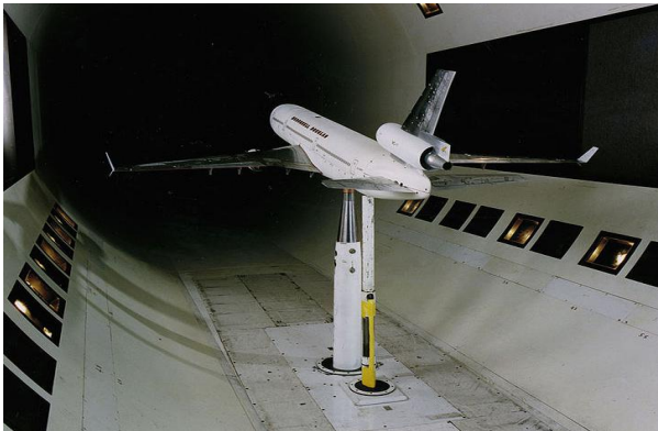
Il·lustració 18: Experimentació d'un avió comercial en un TDV subsònic ( M < 1 ) (Font: Viquipèdia)
