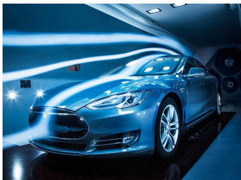
Il·lustració 20: TDV que utilitza aire i fum per mostrar el flux al impactar amb el vehicle (Font: A2 TDV)
