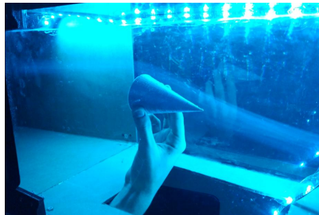
Il·lustració 50: Il·luminació de la zona de test per visualitzar el fum (Font: Pròpia)
