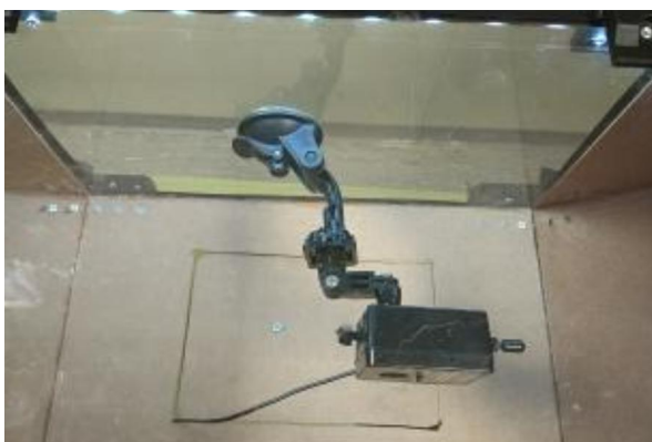
Il·lustració 48: Sistema de sensors de les forces horitzontals (Font: Pròpia)
