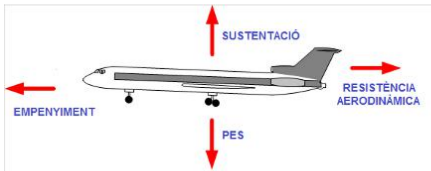
Il·lustració 1: Mostra de les quatre forces que actuen en un avió a velocitat constant (Font: Langley Flying School)
