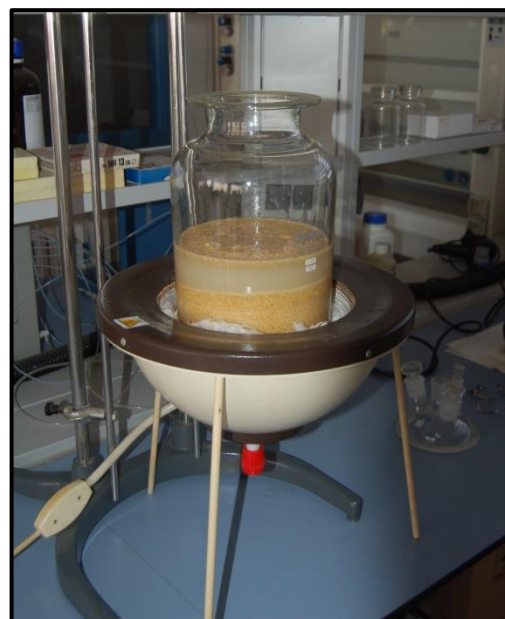
Figura 6-3. Baló de destil·lació amb la mostassa mòlta i l'aigua. Font: Pròpia
