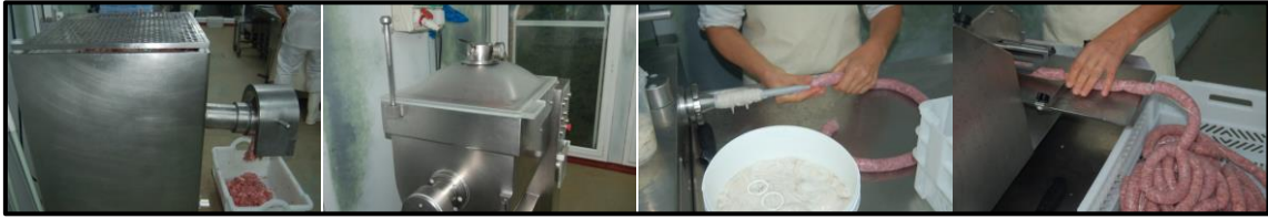
Figura 3-10. Procés d'elaboració de les botifarres a Cal Rovira. D'esquerra a dreta: picar la carn, barrejar-la, embotir-la i lligar. Font: Pròpia
