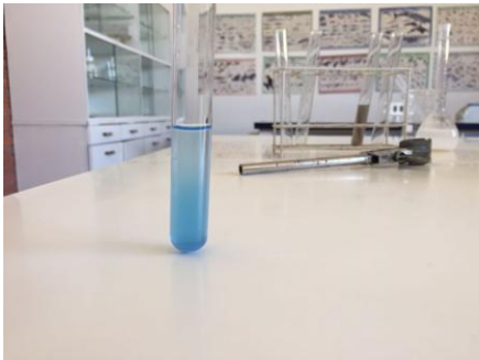
Figura 19. Tub d'assaig amb la reacció esmentada després d'afegir-hi Fehling i deixar-ho escalfar. S'ha mantingut blau, per tant el midó no ha estat hidrolitzat i per aquest motiu no reacciona.
