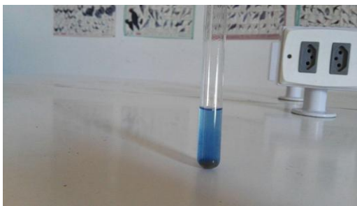
Figura 23. Dissolució de midó i amilasa durant 15 minuts a 34.5°C, en la qual s'hi ha afegit Fehling i gairebé no ha reaccionat.
