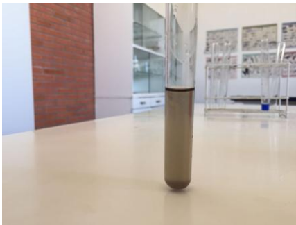
Figura 11. Tub d'assaig amb la dissolució enzimàtica, de midó i aigua destil·lada després d'afegir-hi unes gotes de Lugol.
