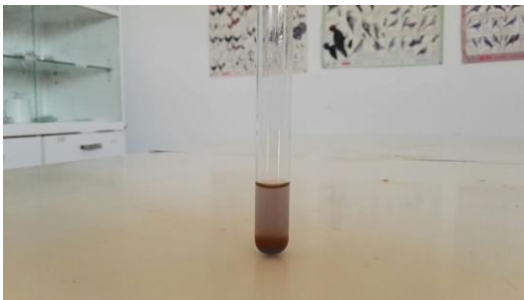
Figura 12. Tub d'assaig amb la dissolució enzimàtica, de midó i aigua destil·lada després d'afegir-hi Fehling i deixar-ho escalfar.
