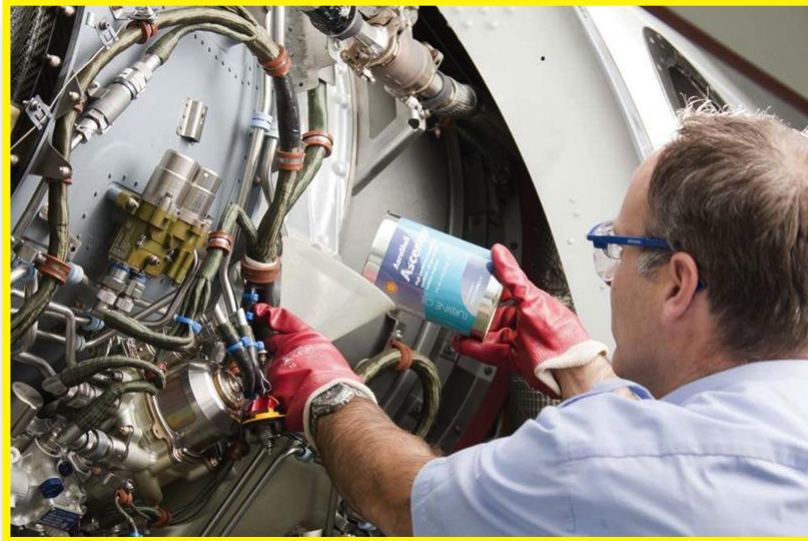
Imatge 3. Operari introduint fluid hidràulic en un motor d'un Airbus A380.
