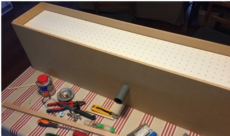
Imatge 16. Vista superior del carril després d'haver ajuntat les quatre planxes exteriors i els tubs corresponents a l'entrada de l'aire.
