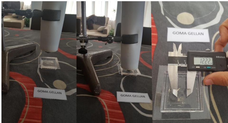
Imatge 63: en aquesta imatge es veu l'aplicació de la duresa Brinell a la goma gellan.
