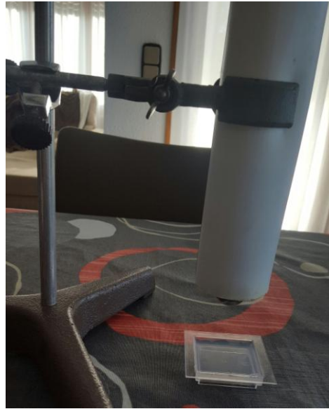
Imatge 44: aparell per mesurar la duresa
