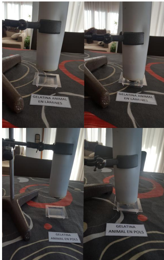
Imatge 47: en aquesta imatge s'hi pot veure l'aplicació de la de l'aparell de duresa Brinell sobre la gelatina animal en làmines i en pols.
