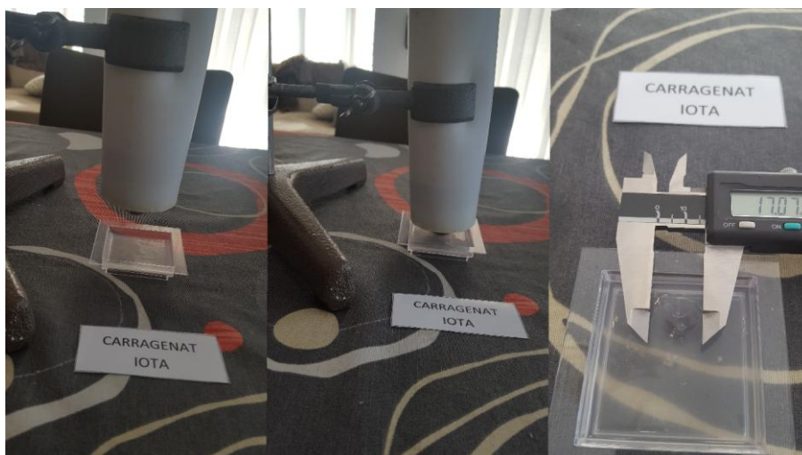
Imatge 55: en aquesta imatge es veu l'aplicació de la duresa Brinell al carragenat iota.
