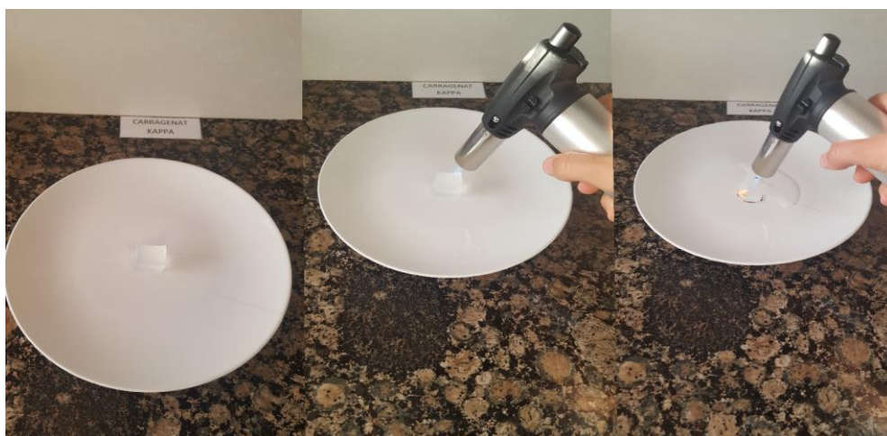
Imatge 58: en aquest imatge es veu l'aplicació directa de calor sobre el carragenat kappa.
