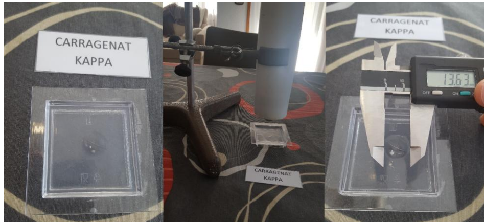
Imatge 59: en aquesta imatge es veu l'aplicació de la duresa Brinell al carragenat kappa.
