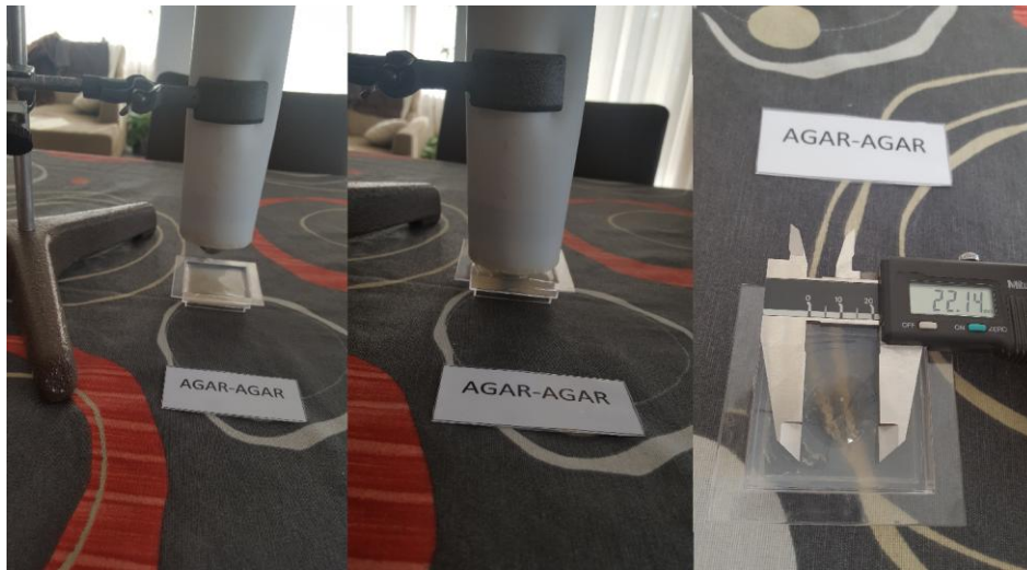
Imatge 51: en aquesta imatge es veu l'aplicació de la duresa Brinell a l'agar-agar.
