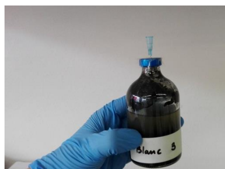
Figura. 3. Procés d'extreure la pressió amb una agulla emmanegada
