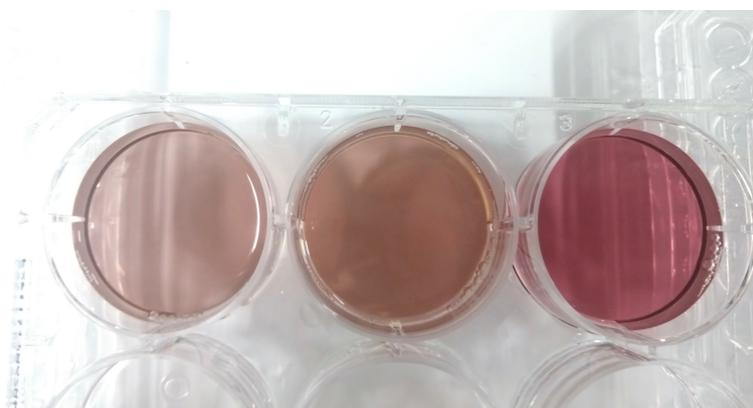
Figura 11: Muestras de AuNPs Cilindros #1, Cilindros #2 y Cilindros #3, tras la síntesis. La diferencia de color indica la obtención de nanocilindros de distinto *aspect ratio*. Realización: 18/07/2016
