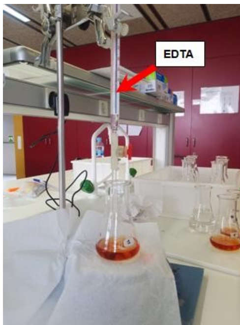
Figura 10. Mètode complexomètric a UVic.
