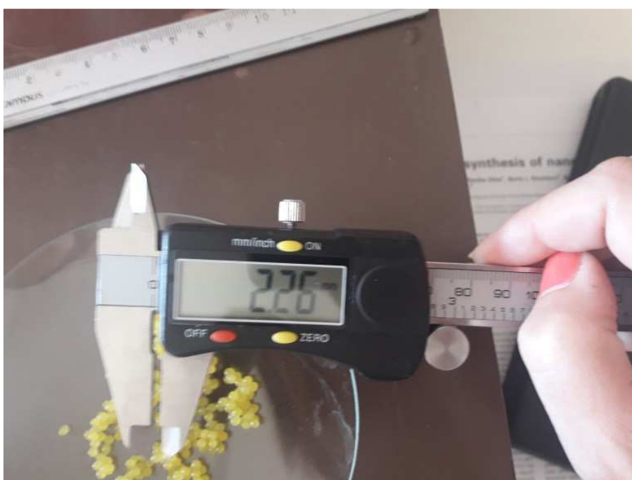
Figura 23. Mida de les boles d'alginat de calci amb el peu de rei.
