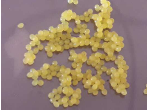
Figura 15. Boles de peles de mandarina encapsulades en alginat de calci.
