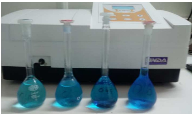
Figura 10. Solucions preparades de BM de 0.15 g/L, 0.3 g/L, 0.45 g/L i 0.6 g/L per la recta de calibració.
