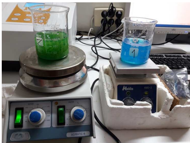
Figura 17. Procediment de sorció de les boles d'alginat de calci (erlemmeier 1) i les peles de mandarina encapsulades en les boles d'alginat de calci (erlemmeier 2).
