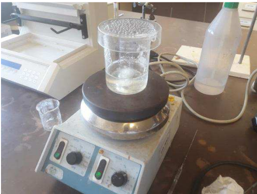
Figura 19. Dissolució del 1% d'alginat de sodi en aigua (1g d'alginat de sodi en 100 mL d'aigua destil·lada).
