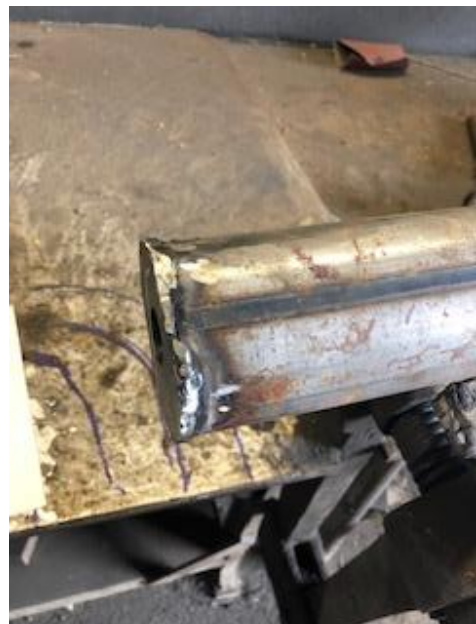
6.12 Imatge del tap soldat vist des de la vista lateral.
