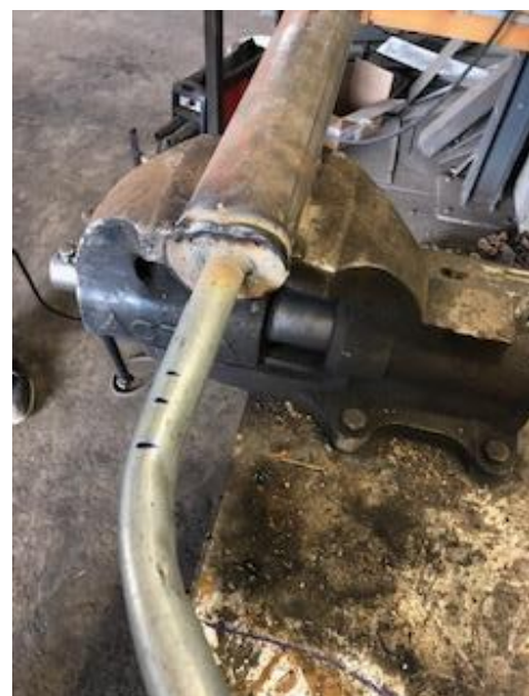
6.14 Imatge una vegada la canya ha estat soldada en el tap.
