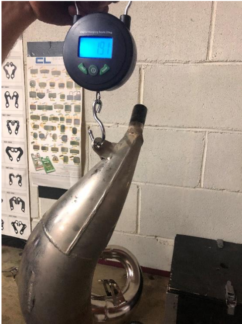
5.21 Imatge on ens mostra que el pes de la bufanda de sèrie és de 1,91kg.
