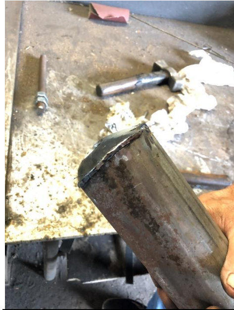
6.27 Imatge del resultat final després de la soldadura de les dues peces.
