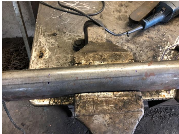
6.31 Imatge de les marques fetes al silenciador, indicant la posició on es soldaran els suports.
