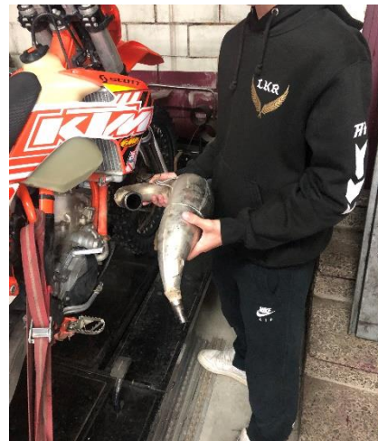
5.13 – 5.15 Imatges desmuntant la bufanda (escapament) de sèrie.
