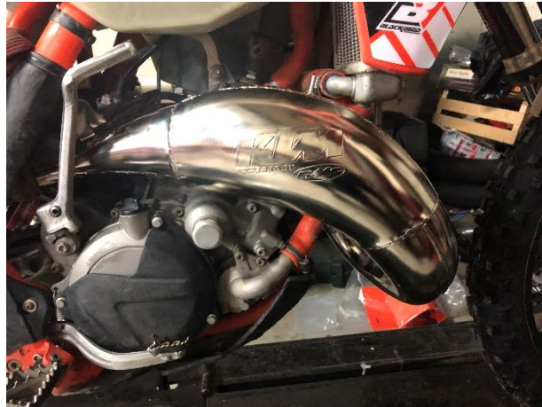
5.26 Imatge de la bufanda del sistema d'escapament de competició. Com es pot observar, la peça porta gravada el logotip de la marca.
