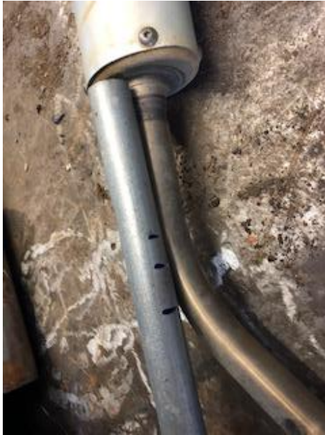
6.3 Imatge de les marques fetes al tub per saber els llocs exactes on l'hem de doblar.
