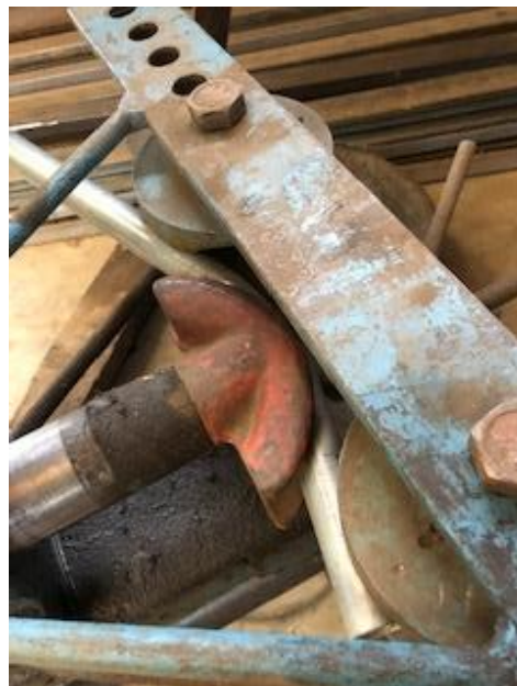
6.6 Imatge del tub a la dobladora mentre és treballat.
