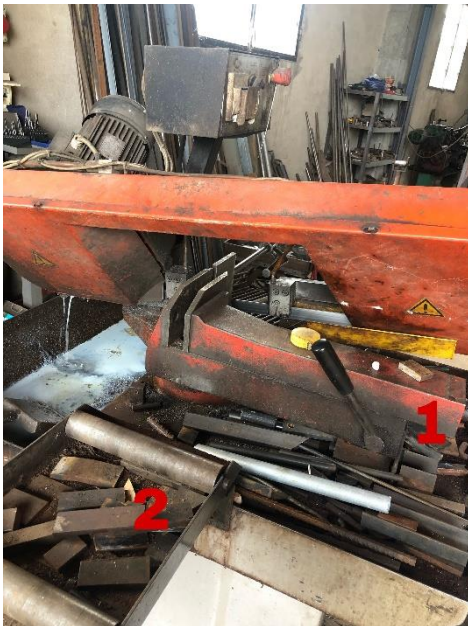
6.28 Imatge de la serra i les peces que utilitzarem per fer els suports.
