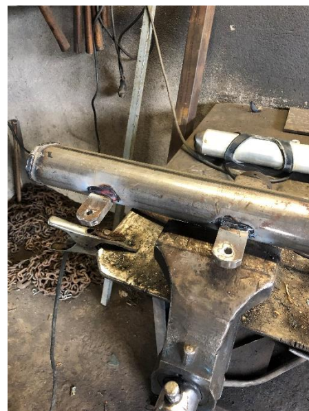
6.33 Imatge del silenciador amb els suports soldats.
