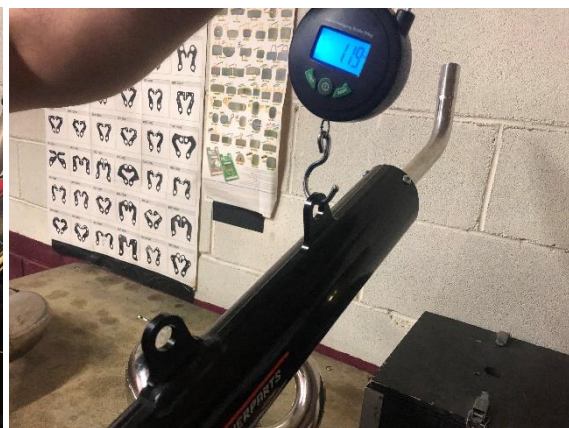
5.24 Imatge on ens mostra que el pes del silenciador de competició és de 1,19kg.
