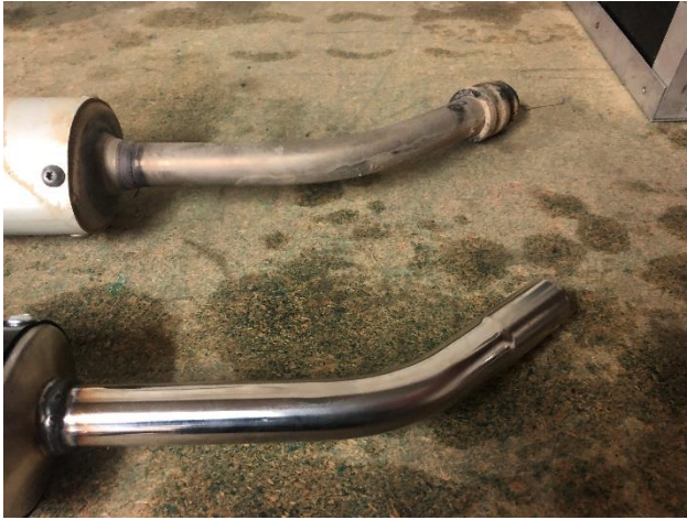
5.19 Imatge de la longitud de les canyes dels silenciadors de la comparativa.
