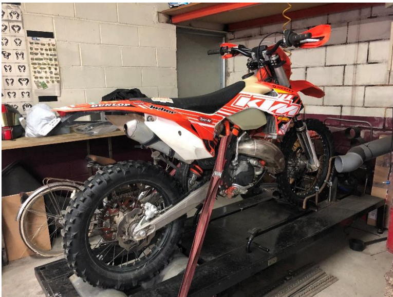
5.6 – 5.9 Imatges de la moto pujada i fixada en el banc de potencia amb el sistema d'escapament de sèrie.
