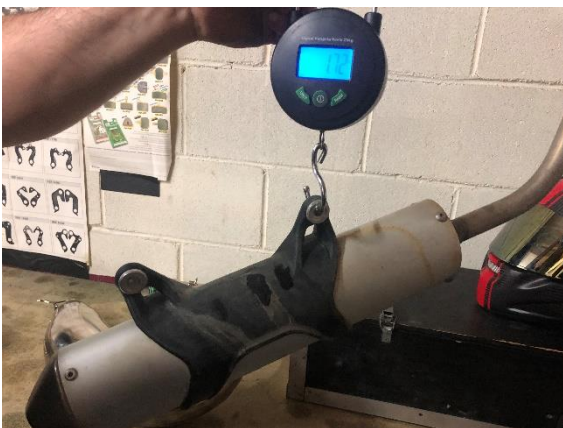
5.23 Imatge on ens mostra que el pes del silenciador de sèrie és de 1,72kg.
