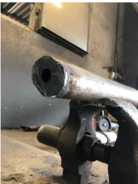
6.13 Imatge del tap soldat vist des de la vista frontal.
