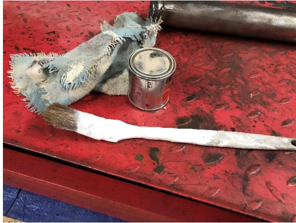
6.38 Imatge de la pintura anticorrosiva emprada per pintar el silenciador.
