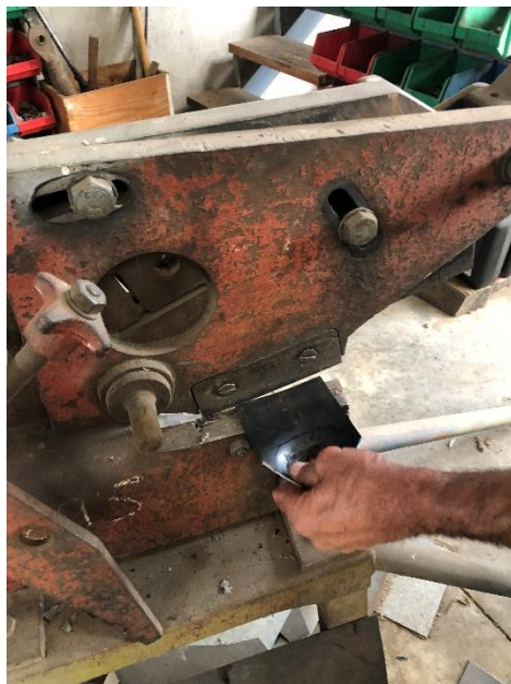
6.19 Imatge de la cisalla manual mentre treballa la peça.
