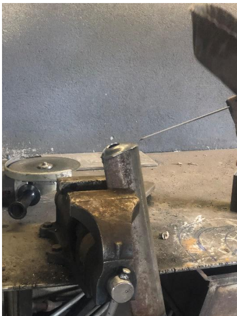
6.23 Imatge del silenciador soldat pels costats.
