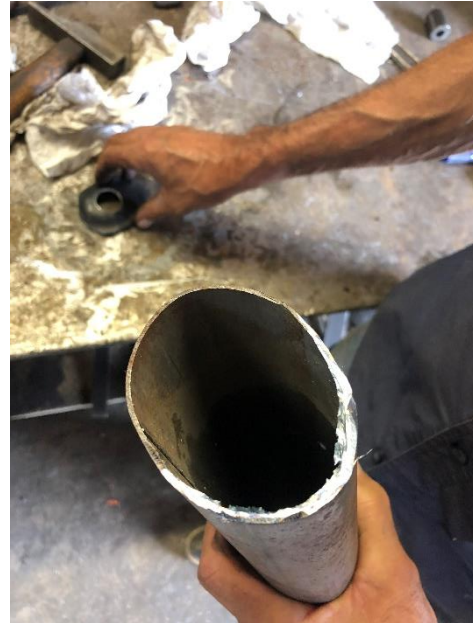
6.22 Imatge del silenciador, on es veuen els contorns d'un dels costats rebaixats per facilitar l'encaixament.
