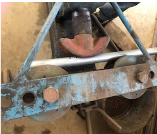
6.5 Imatge del tub a la dobladora abans de ser treballat.
