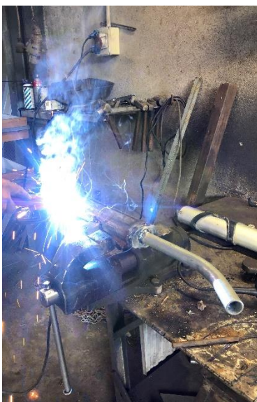
6.32 Imatge del silenciador mentre se solden els suports.
