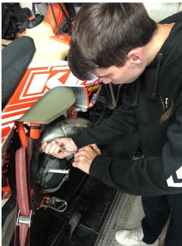
5.13 – 5.15 Imatges desmuntant la bufanda (escapament) de sèrie.
