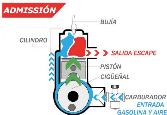
3.2.- Exemple gràfic de l'etapa d'admissió d'un motor 2T
