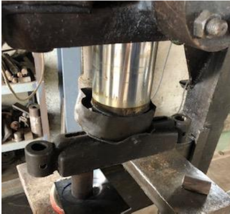
6.17 Imatge de la peça sent treballada per la premsa.
