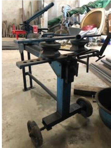
6.4 Imatge de la dobladora de tubs, màquina amb molts anys d'història amb escàs servei en l'actualitat.
