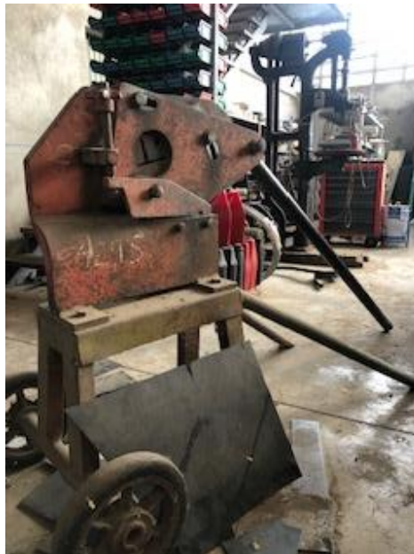
6.10 Imatge de la cisalla manual, la qual és una màquina de procedència artesanal.
