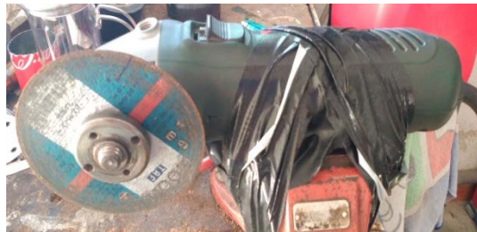
Radial agafada a un cargol de banc
