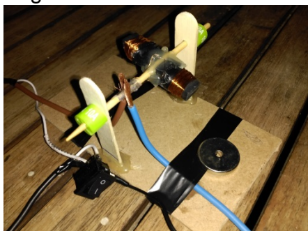
Motor elèctric acabat
