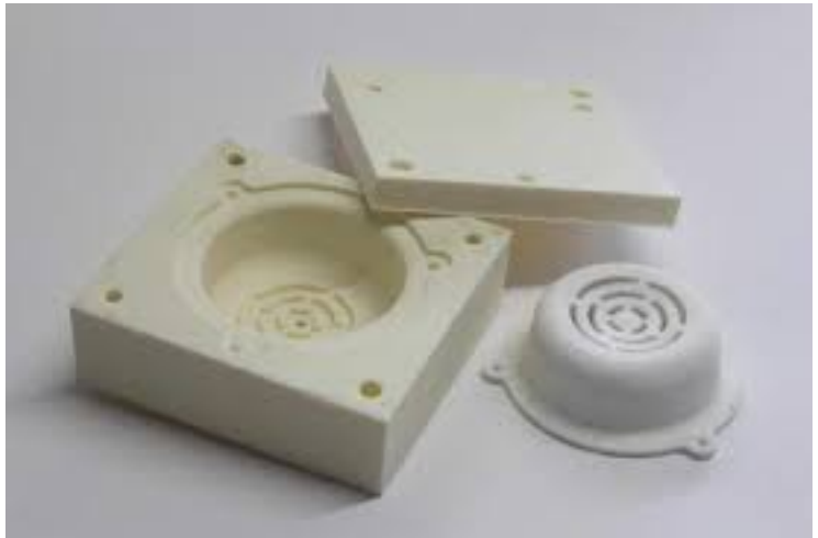
Motlle emprat a la injecció de material i objecte resultant.
