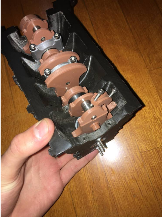
Foto de la unió del conjunt dels pistons al cigonyal a través de la tapa de la biela.
