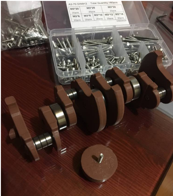
Foto del muntatge del cigonyal i dels caragols utilitzats per a muntar el motor.
