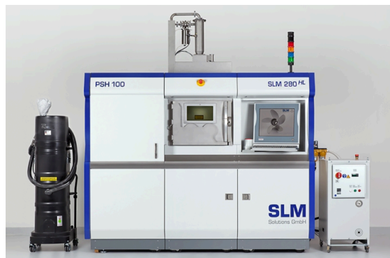
Impressora de fusió selectiva per làser.
