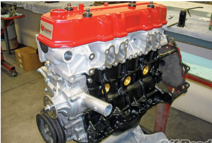
Foto del motor Toyota 22R-E.
