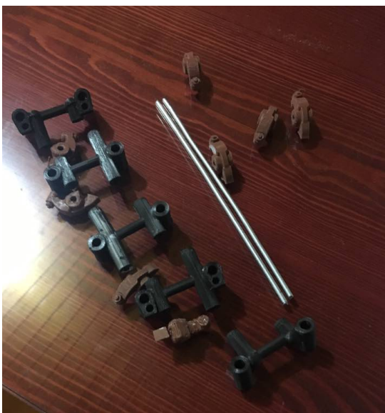
Imatge del material necessari per poder muntar l'estructura dels balancins.
