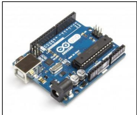
Figura 9.4 Placa Arduino Uno, similar a la utilitzada. Font: Arduino
