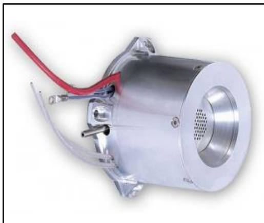
Figura 4.11 Propulsor d'ions. Font: Airbus
