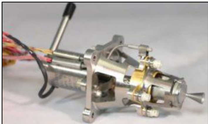
Figura 4.8 Propulsor de hidrazina. Font: Masse et al. (2015)
