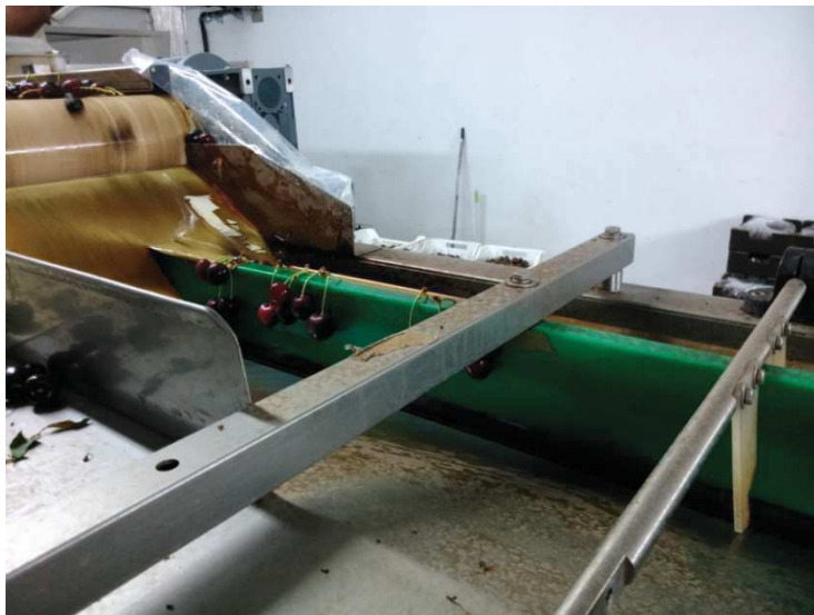
Imatge 58: màquina que separa les cireres segons si tenen peduncles junts o no
