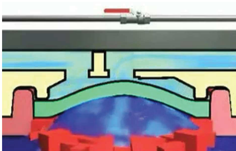
Imatge 44: esquema d'un degoter autocompensant en funcionament. Font: canal de YouTube de ramiro8357
