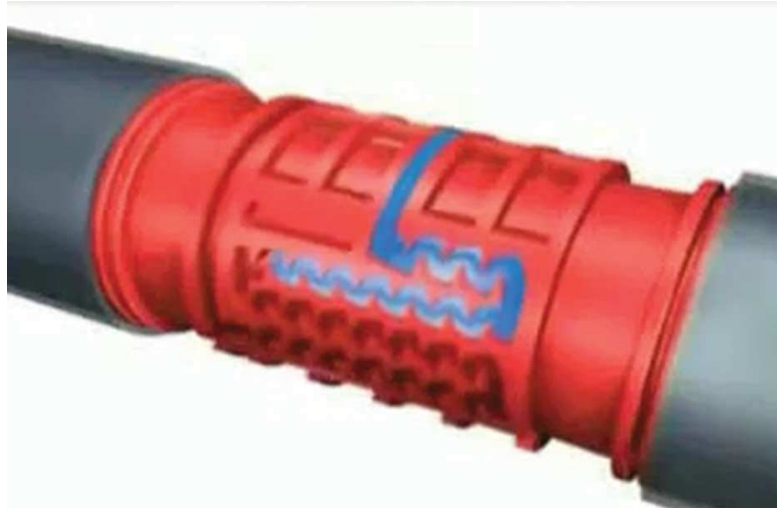
Imatge 46: estructura interna i funcionament d'un degoter convencional. Font: canal de YouTube de ramiro8357
