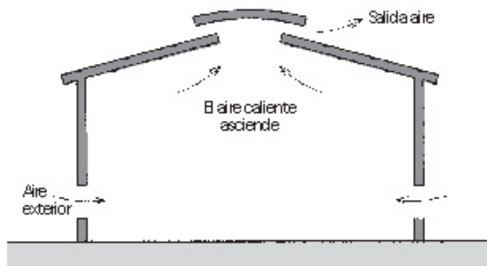
Imatge 40: esquema del procés de ventilació natural. Font: Soler & Palau
