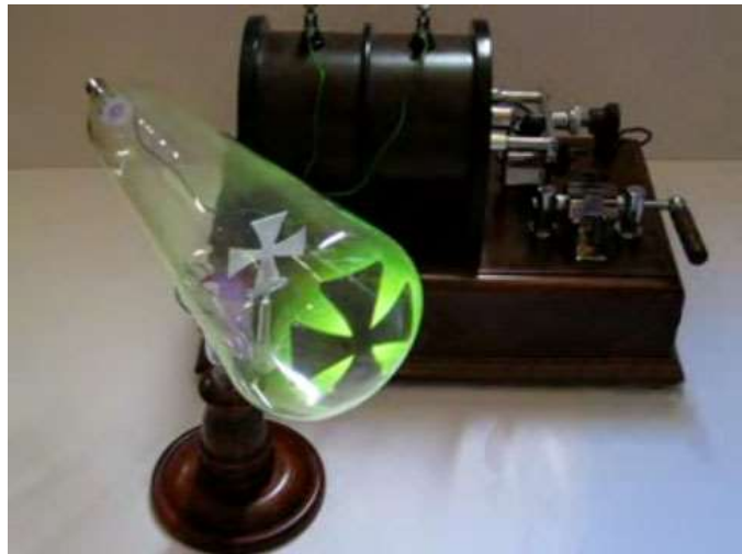
Tub de Crookes o de rajos catòdics. Figura 22.
