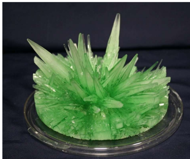
Cristal·lització del sulfat monoamònic mitjançant el procés de cristal·lització per refredament. Figura 6.
