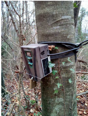
Figura XVII. Càmera Scout Guard SG575 de trampeig fotogràfic instal·lada en un arbre amb tots els sistemes de seguretat
