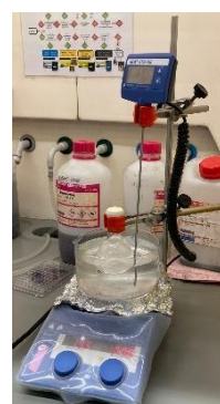
Ilustración 26: montaje para calentar y agitar magnéticamente el balón. Fuente: propia.
