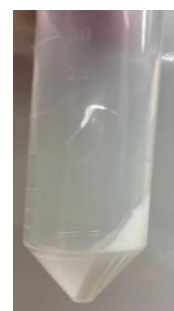
Ilustración 23: tubo de centrifugación con las NPs precipitadas en su interior y sin sobrenadante. Fuente: propia.
