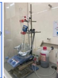
Ilustración 22: montaje para calentar, agitar magnéticamente y condensar el contenido del balón. Fuente: propia.
