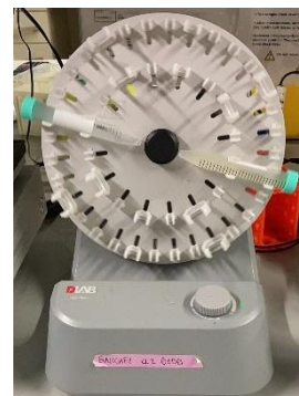
Ilustración 27: posición de los 2 tubos para centrífuga en el agitador rotativo. Fuente: propia.
