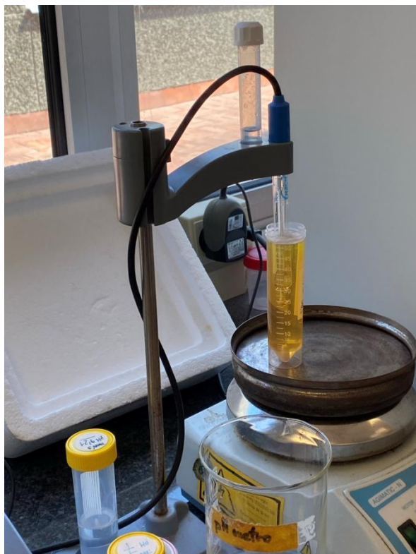
Figura 19: Elaborant una solució d'un pH determinat amb el pH-metre.
