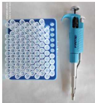
Micropipeta i puntes (100-1000 \mu L)
