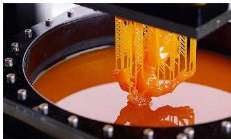
Imatge 1. Impressió per estereolitografia. Extret de www.3Dnatives.com
