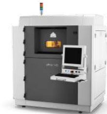
Imatge 2. Impressora de sinterització selectiva per làser. Extret de www.3Dnatives.com
