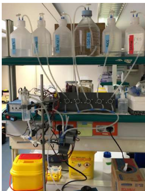
Imatge 36. Mecanisme de descel·lularització de teixits. Font pròpia
