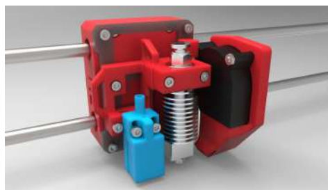
Imatge 4. Capçal d'una impressora 3d. Extret de 3dwork.io
