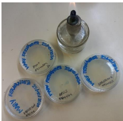
figura 33. Plaques de petri anomenades amb l'aigua de cada zona. Tubs amb 13mL d'aigua de cada columna. Font pròpia (08/11/2021)
