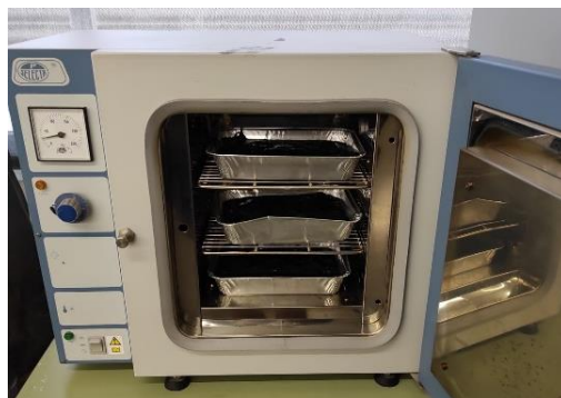
figura 23. Forn d'assecat del laboratori amb tres safates de substrat . font pròpia (08/11/2021)
