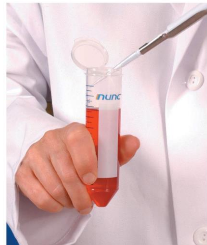
Figura 40: Exemple tub cònic per a centrífuga.
