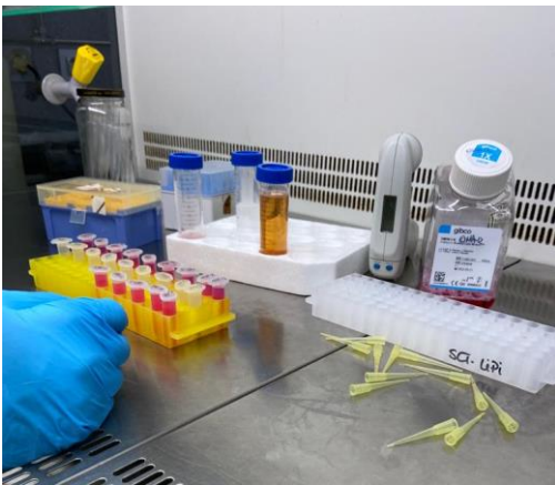
Figura 48: Procés de dissolució dels productes, amb les concentracions de 0,2 i 0,3 mg/mL, en DMEM. Font. pròpia
