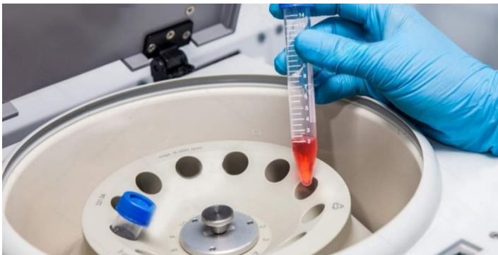
Figura 30: Exemple centrífuga específica de tubs cònics.
