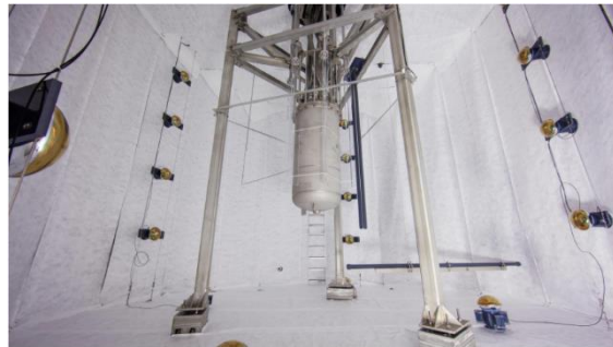
IMATGE 11 – DETECTOR LUX ABANS D'AFEGIR L'AIGUA AL TANC
