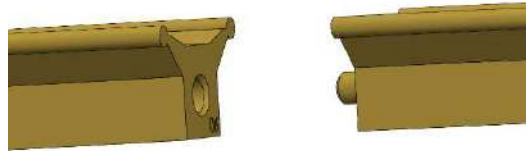
Fotografia 91: Encaix entre peces Font: Pròpia
