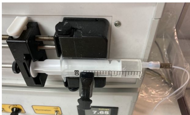
Figura 1.1. Xeringa col·locada en el premador connectada en un petit conducte que transporta el PCL fins a dintre la cabina on surt per l'agulla. El premador va dirigit per un programa que li indica la velocitat i forma amb la que ha de premar perquè, en aquest cas, expulsi 5mL a 6mL/h (Font pròpia).
