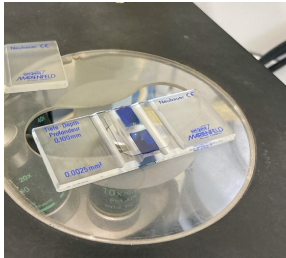
Figura 2.3 Recompte cel·lular amb la tècnica Neubauer. S'observa la Neubauer, la solució de trip and blue amb cèl·lules sota un petit mirall i col·locat al microscopi (Font pròpia).
