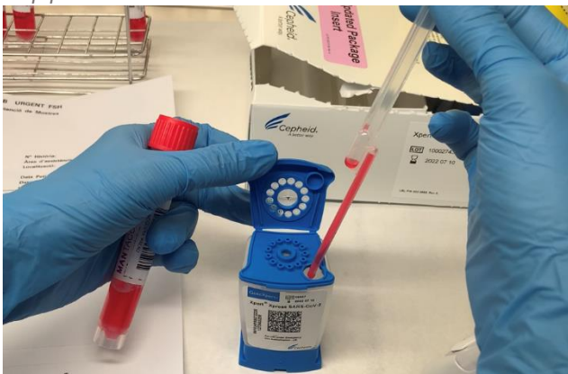
Il·lustració 31. Insertant la mostra dins del cartutx
