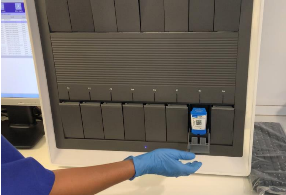
Il·lustració 32. Col·locació del cartutx dins del termociclador.
