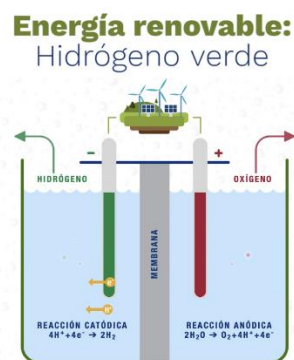
FIG. 19 - representació de l'electròlisi de l'aigua per obtenir hidrogen
