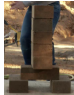
Font 32: Prova de flexo-compresió
