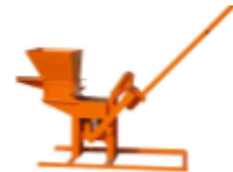
Font 31: Màquina encarregada de premsar els blocs BTC
