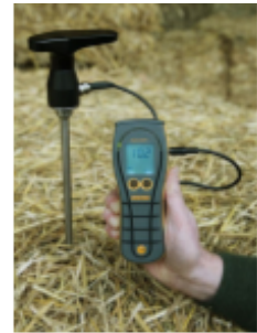
Font 2: Humidímetre per calcular la humitat de la palla
