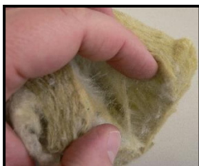
Figura 2.14. Fragment de llana de fibra de roca. Font: ca.wikipedia.org
