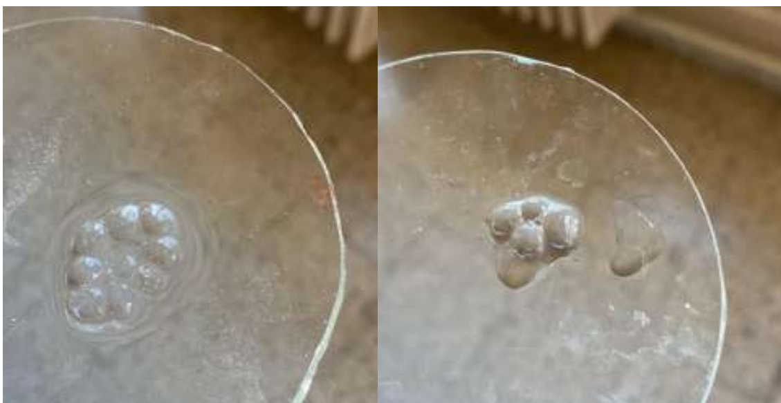
Figura 10: Nanocàpsules d'alginat de sodi i clorur de calci. A l'esquerra, de 0,5 grams i a la dreta d'1 gram.
