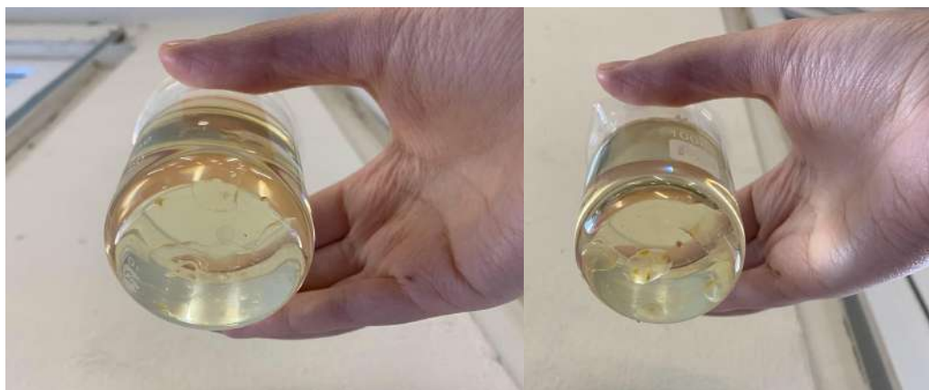
Figura 31: Resultat de les nanocàpsules, de la pràctica 2, a deixar-ho reposar 24 h. A l'esquerra, de 0,5 grams i a la dreta d'1 gram.
