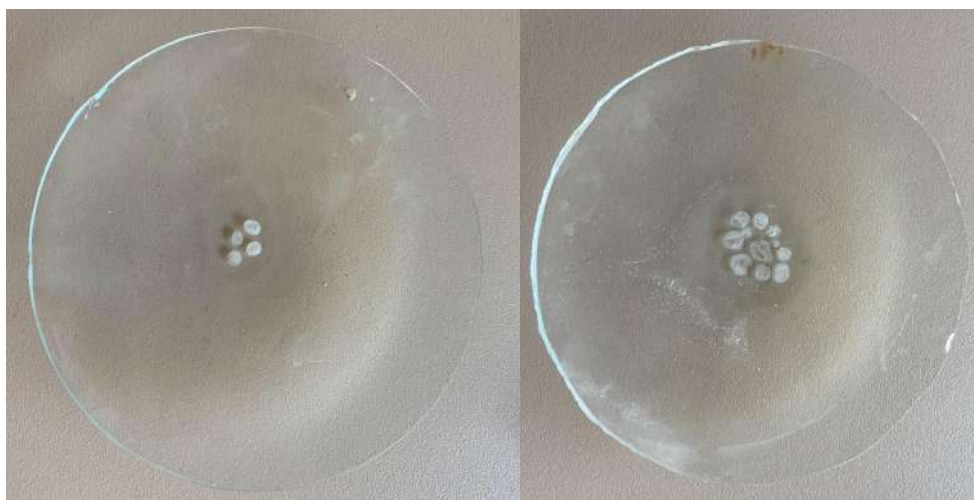
Figura 26: Resultat de les nanocàpsules, de la pràctica 1, a deixar-ho reposar 24 h. A l'esquerra, de 1 grams i a la dreta de 0,5 grams.
