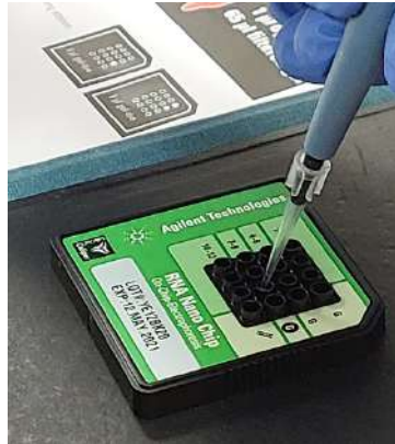
Figura 31. Càrrega de mostres a la matriu (RNA nano Chip) del Bioanalyser amb una micropipeta. Font: Elaboració pròpia
