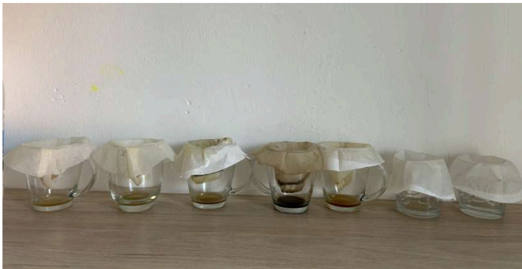
Figura 62: Filtració de les solucions dels càlculs d'estruvita
