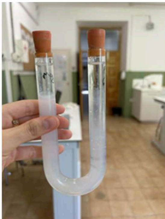
Figura 44: Tub en forma de "U" amb 6 ml de reactiu a cada lateral del tub
