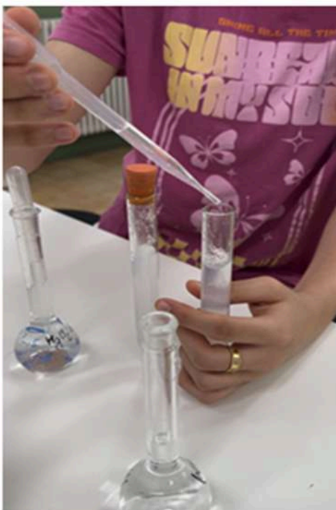
Figura 42: Pipetació del reactiu fosfat d'amoni en el costat esquerre del tub
