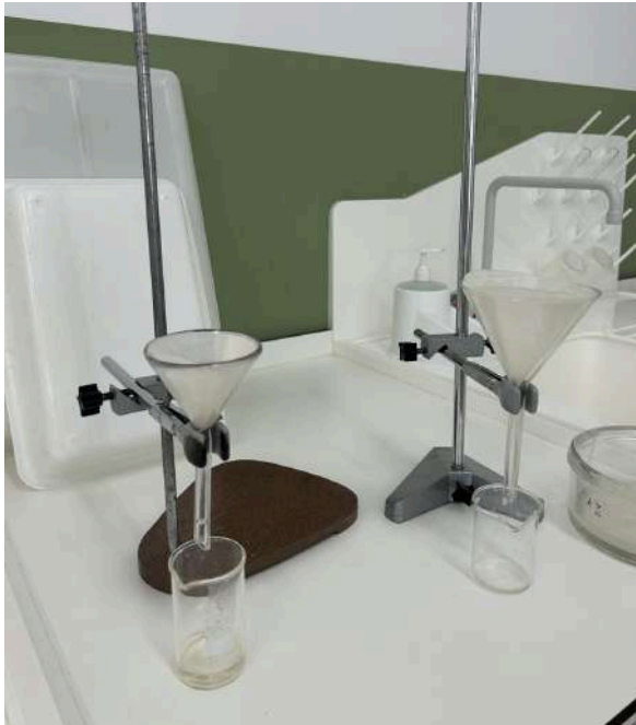
Figura 50: Filtració dels cristalls de l'hidròxid de sodi Font: Pròpia
