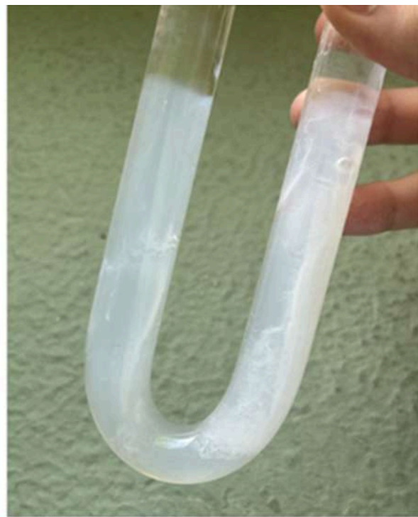
Figura 45: Obtenció de cristalls en el tub amb 8,5 ml de reactiu
