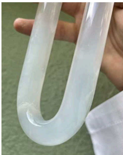
Figura 46: Cristalls en el tub amb 8,5 ml de reactiu
