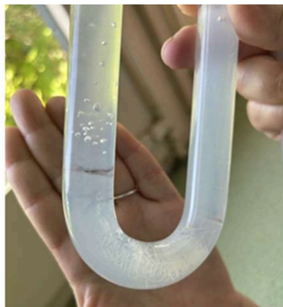
Figura 47: Cristalls obtinguts en el tub amb 6 ml de reactiu
