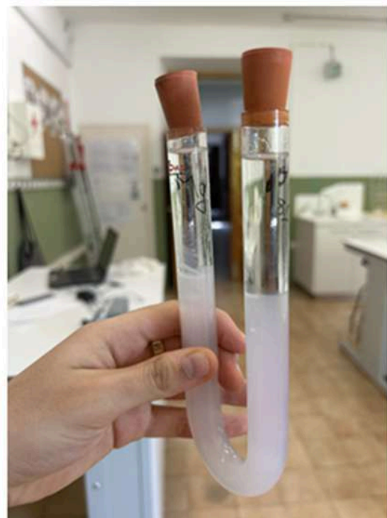
Figura 43: Tub en forma de "U" amb 8,5 ml de reactiu a cada lateral del tub
