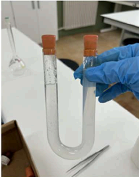
Figura 40: Gel gelificat dins del tub en forma de "U"
