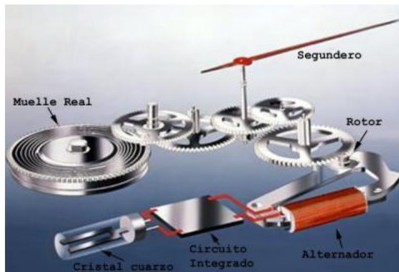
Il·lustració 11: Funcionament d'un rellotge de quars. Font: http://www.inforeloj.com/
