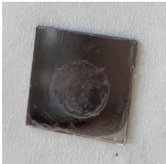
Il·lustració 28: Substrat de silici amb el polímer. Font: Pau Escofet
